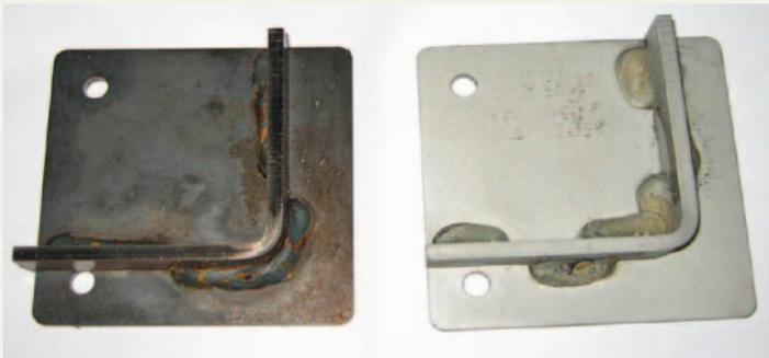
Stahlteile vor und nach der Oxidentfernung
