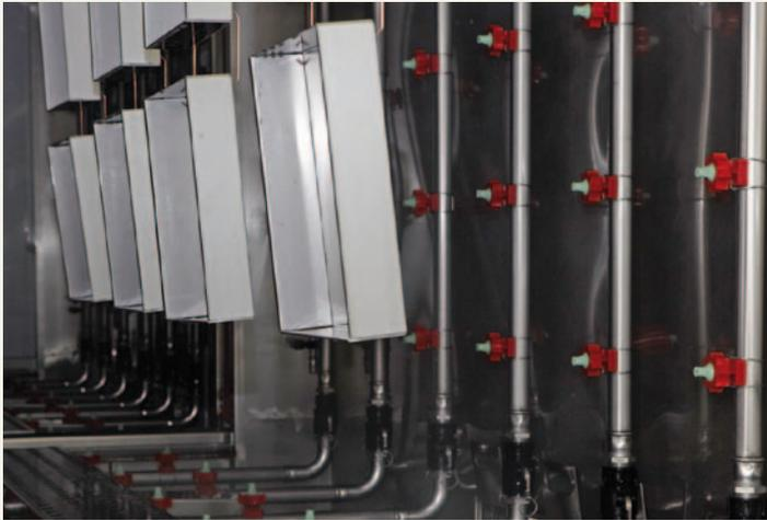
In der Durchlaufzone reinigen Sprühkränze die Teile von Laserzunder und Oxidschichten
