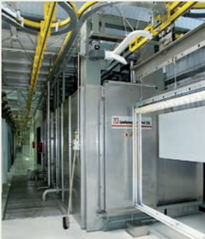
◀ ▲ Nach der nasschemischen Vorbehandlung werden die Gehänge mit der Absenkvorrichtung (rechts) so gekippt, dass das Wasser aus den Blechteilen abfließen kann
