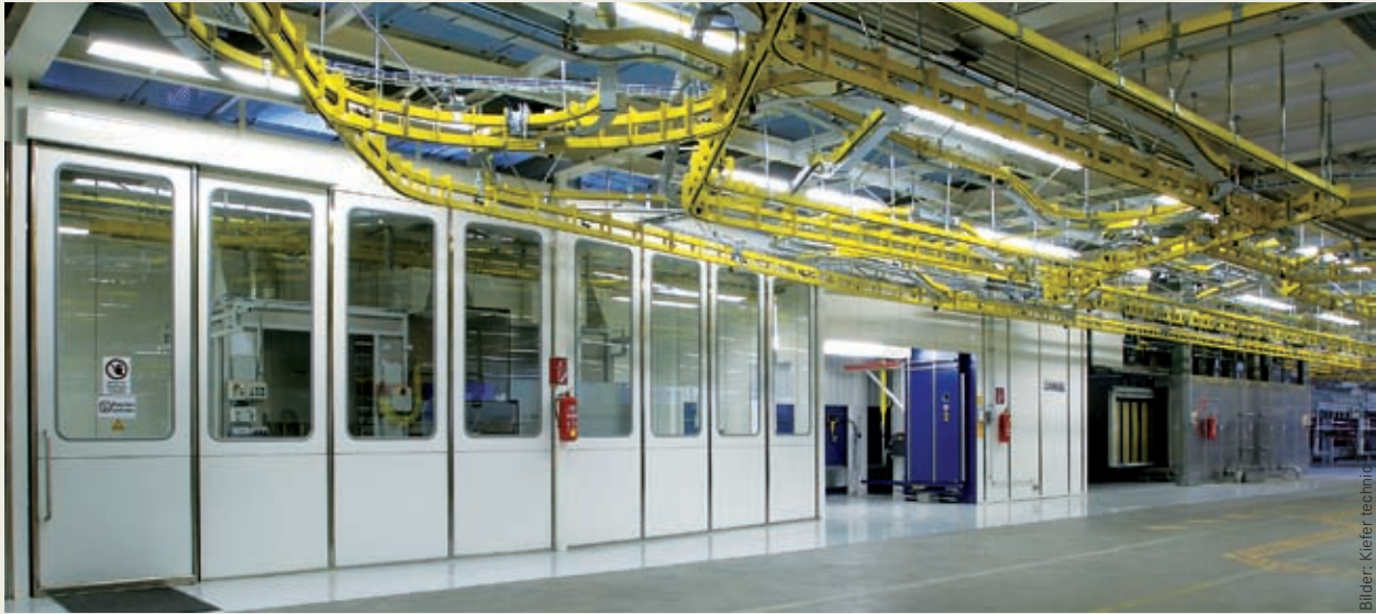
▲ Die Beschichtung der Blechteile erfolgt in einer Reinraum-Pulverkabine
