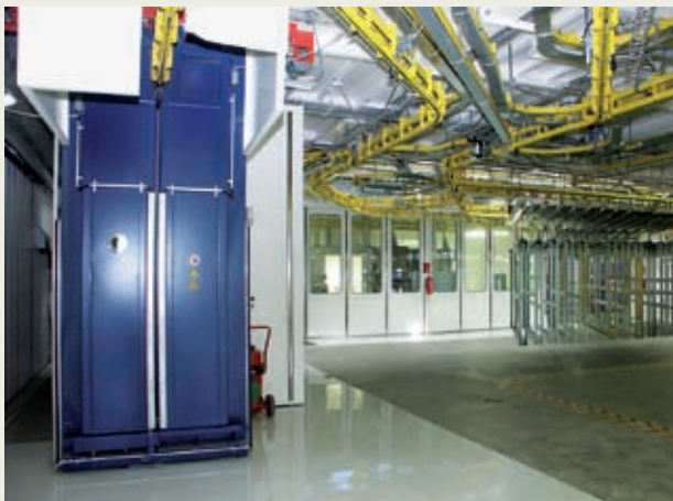
▲ Die Beschichtung der Blechteile erfolgt in einer Reinraum-Pulverkabine
