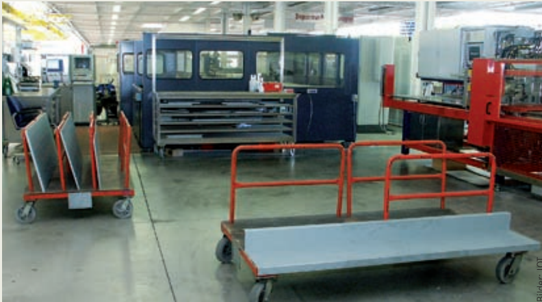
▲ Vor der Installation der aufwendigen Power+Free-Anlage wurden die einzelnen Blechteile auf 150 solcher Handwagen durch die Fertigungshalle transportiert
