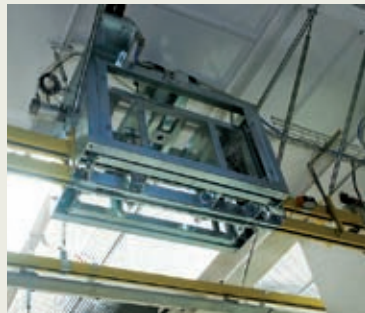
◀ ▲ Nach der nasschemischen Vorbehandlung werden die Gehänge mit der Absenkvorrichtung (rechts) so gekippt, dass das Wasser aus den Blechteilen abfließen kann
