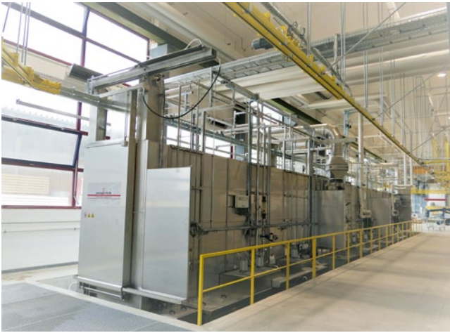
Die Vorbehandlung erfolgt automatisch in einer Anlage mit neun Behandlungsstufen. Die Konversionsbehandlung ist Chrom(VI)-frei.
