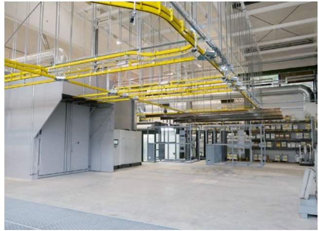
Der Haftwassertrockner (links) ist energiesparend als Blocktrockner mit dem Einbrennofen gekoppelt.
