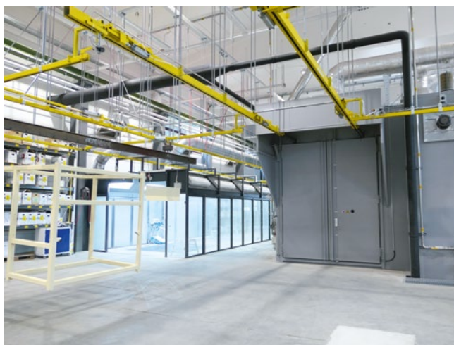
In der Großraumkabine links können bis zu 7 Meter lange Teile manuell beschichtet werden. Glaswände und beidseitige Lichtleisten sorgen für eine helle Arbeitsumgebung.
